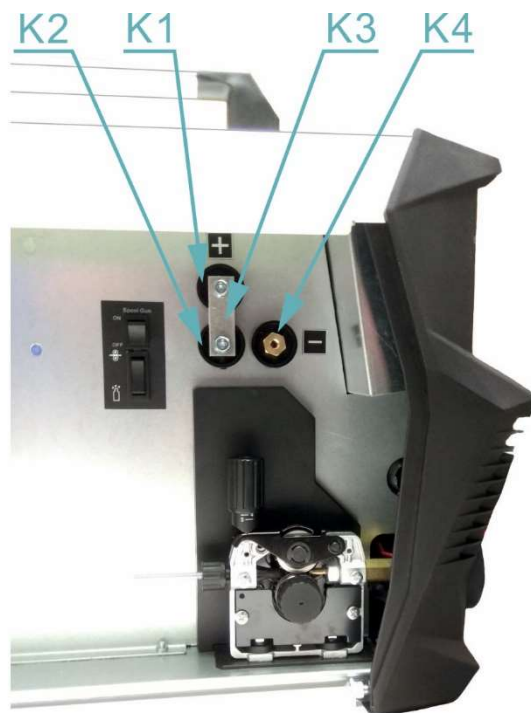
Obrázek 13. Detail terminálů změny polarity MIG/MAG hořáku
